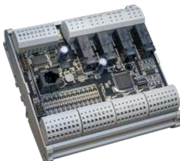
Figure 28 : Automate de régulation
